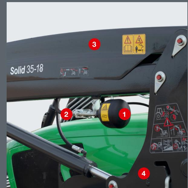
O Comfort-Drive assenta de forma protegida entre a coluna e o braço do carregador. Pode ser ligado e desligado através de uma torneira.
