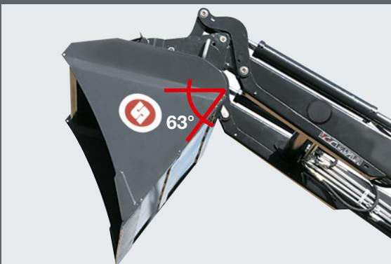
Assim, o balde fica completamente vazio - o ângulo com o balde reclinado para baixo proporciona uma descarga total.
