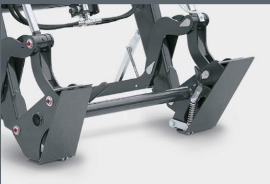
O espelho de engate "Skid steer" é específico para a gama FC compactline.
